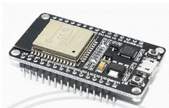
รูปที่ 2.1 บอร์ดไมโครคอนโทรลเลอร์ ESP32-WROOM [3]
