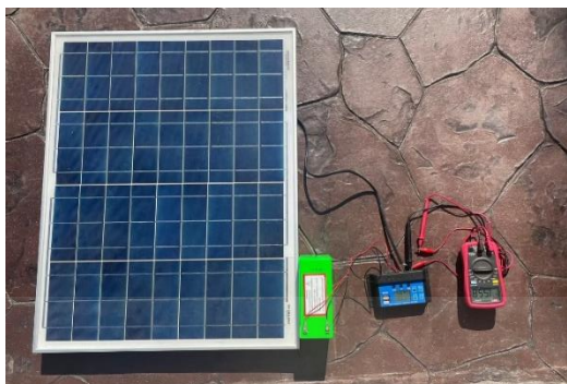
รูปที่ 4.8 การชาร์จแผงพลังงานแสงอาทิตย์เข้ากับแบตเตอรี่
