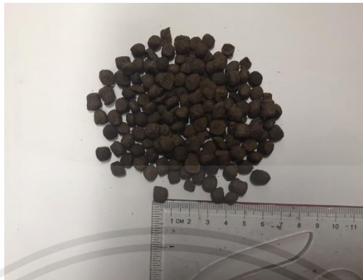
รูปที่ 4.11 อาหารปลา ที่มีเส้นผ่าศูนย์กลาง 0.7 เซนติเมตร ใช้ในการทดสอบการปล่อยอาหารปลา
