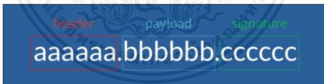
รูปที่ 2.17 ส่วนของ Header Payload และ Signature [30]
