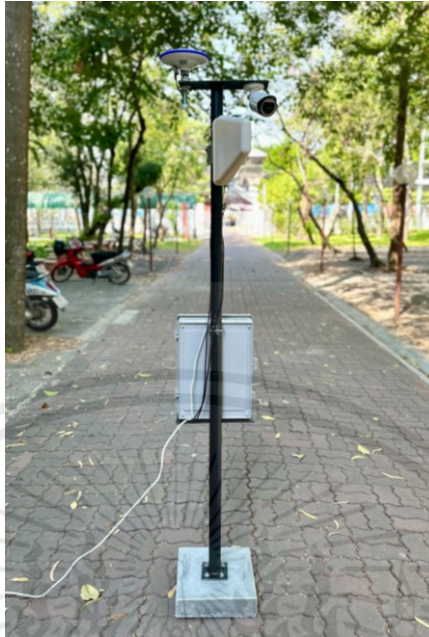
รูปที่ 3.69 เสาของระบบตรวจจับสัญญาณรบกวนจีเอ็นเอสเอส (ด้านหน้า)
