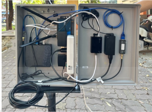
รูปที่ 3.66 การวางอุปกรณ์ทั้งหมดสำหรับระบบตรวจจับสัญญาณรบกวนจีเอ็นเอสเอสลงกล่อง
