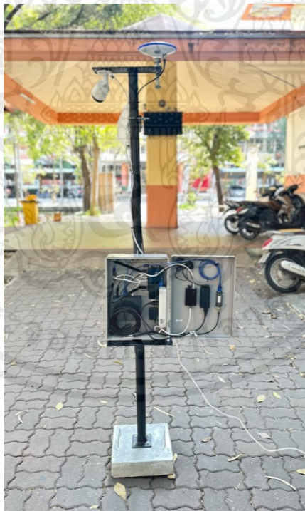
รูปที่ 3.70 เสาของระบบตรวจจับสัญญาณรบกวนจีเอ็นเอสเอส (ด้านหลัง)
