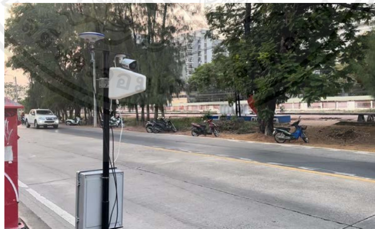
รูปที่ 4.16 บริเวณที่ติดตั้งเสาเพื่อทดสอบการใช้งานของระบบตรวจจับสัญญาณรบกวน
