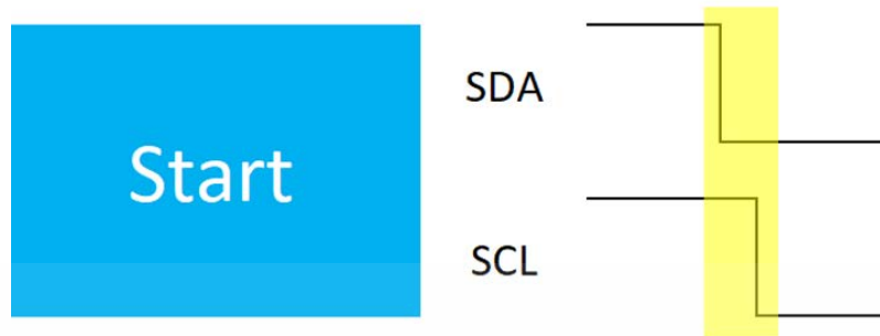
รูปที่ 2.1 การส่งสัญญาณเริ่มต้นส่งข้อมูล (Start)
