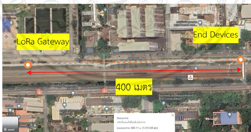
รูปที่ 4.17 การทดสอบวัดระยะทางที่ไกลที่สุดที่รับและส่งข้อมูลได้
