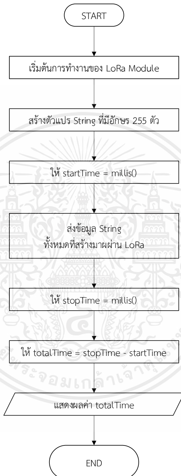
รูปที่ 3.64 แผนผังการออกแบบทดสอบความเร็วในการส่งข้อมูลที่แต่ละ SF
