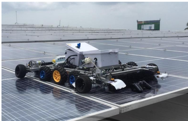
รูปที่ 3.26 หุ่นยนต์ควบคุมผ่าน Joystick
