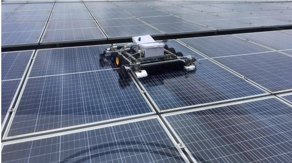
รูปที่ 4.17 หุ่นยนต์วิ่งออกเสียงขวาเมื่อขณะเคลื่อนที่
