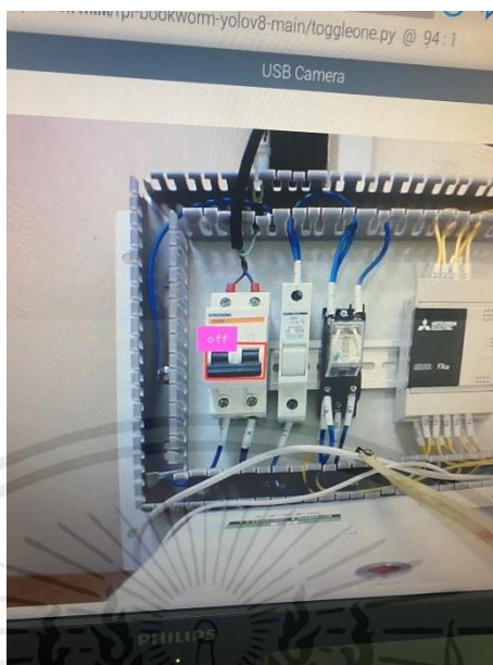
รูปที่ 4.63 การตรวจจับสถานะ OFF ของสวิตช์ก้านยาวในระยะ 40 เซนติเมตร
