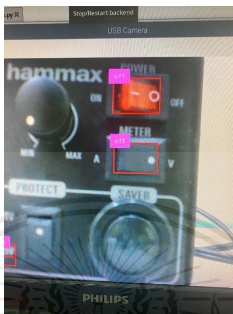
รูปที่ 4.79 การตรวจจับสถานะ OFF ของสวิตช์แบบกระดกในระยะ 10 เซนติเมตร
