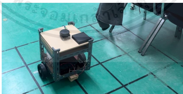
รูปที่ 3.6 การออกแบบให้หุ่นยนต์เคลื่อนที่แบบ Diff-Drive
