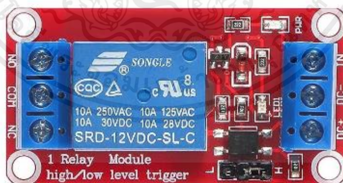
รูปที่ 2.15 DC Relay module
