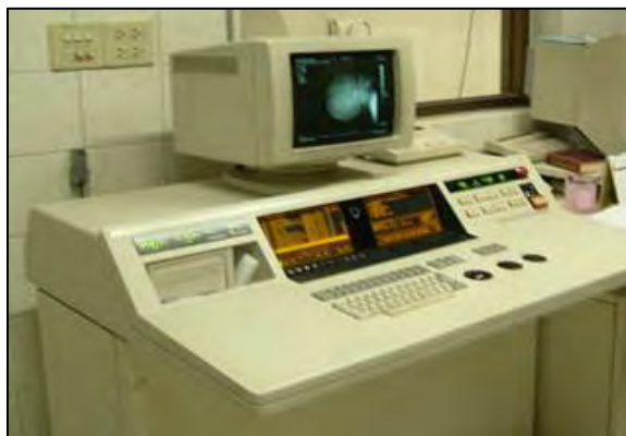
รูปที่ 2.9 ส่วนควบคุมปฏิบัติการและแสดงภาพ (operating console)
