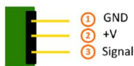
รูปที่ 2.3 Pinout ของ KY-031 Arduino Knock Impact Sensor
