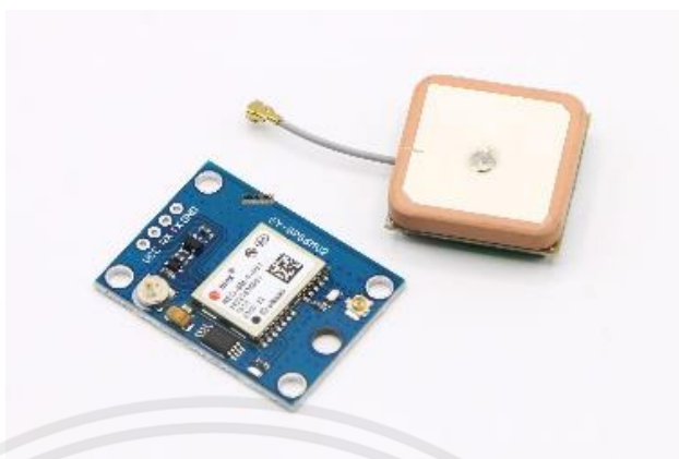
รูปที่ 2.1 โมดูลจีพีเอส Ublox GYGPSV1 NEO-6M GPS module
