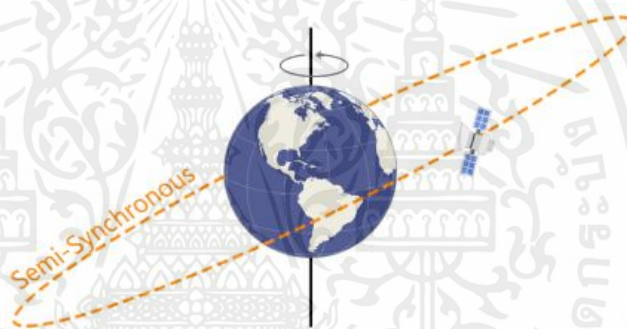
รูปที่ 2.9 วงโคจรเซมิซิงโครนัส (Semi-Synchronous Orbit)
