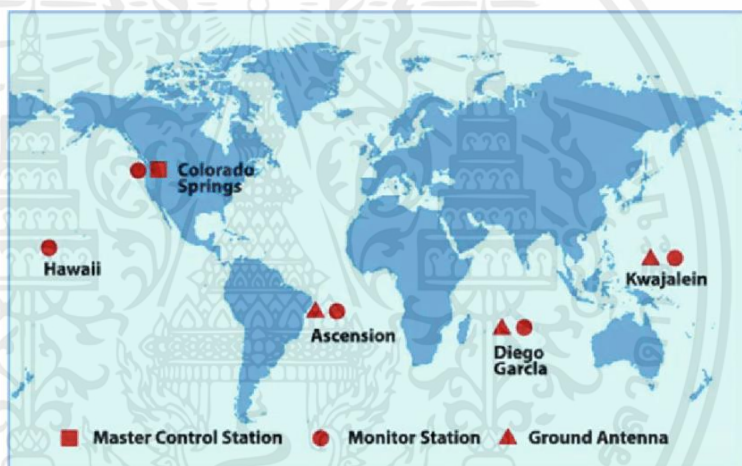
รูปที่ 2.11 ที่ตั้งของสถานีควบคุมหลัก สถานีติดตามดาวเทียม และสถานีรับส่งสัญญาณ
