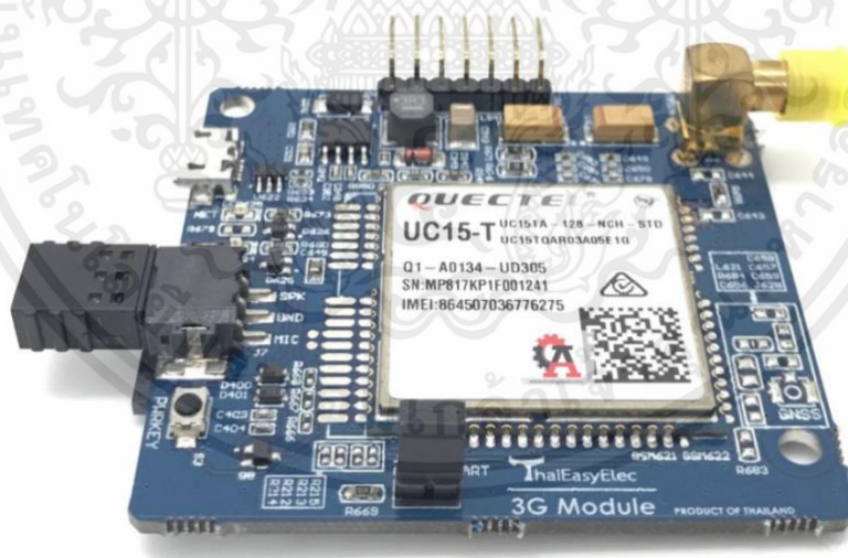
รูปที่ 2.8 บอร์ด 3G Module (UC15-T)
