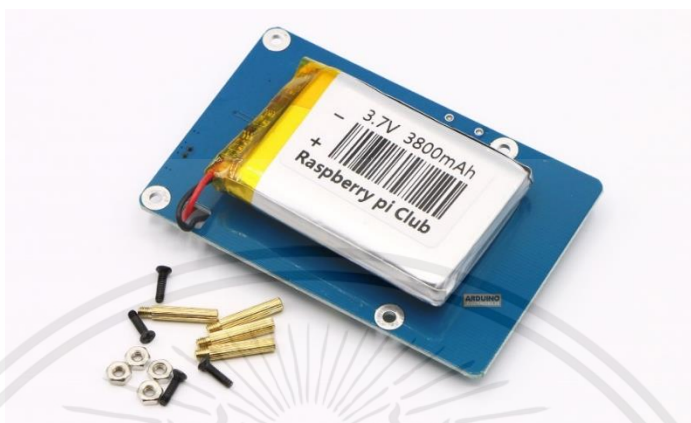
รูปที่ 2.24 Lithium Power Expansion Board for Raspberry Pi
