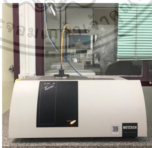
รูปที่ 3.5 เครื่อง Thermogravimetric Analyzer (TG209F3 Tarsus, Netzsch, Germany)
