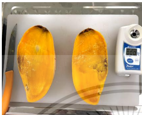
รูปที่ 3.4 การวัดปริมาณของแข็งละลายน้ำได้ด้วยเครื่อง Pocket Refractometer (PAL-1 S/No L218454, Atago, Japan) (ก) โดยการแบ่งเป็น 3 ส่วน หัว กลาง หาง (ข)
