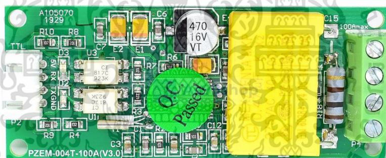
รูปที่ 4.9 ชุดโมดูลวัดแรงดันไฟฟ้ากระแสสลับ PZEM-004T
