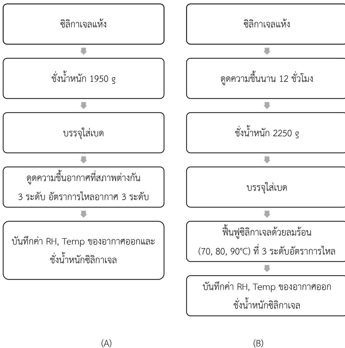
รูปที่ 3.6 แผนการทดลองเพื่อการศึกษาปัจจัยที่มีผลต่อกระบวนการลดความชื้นอากาศ (A) และการฟื้นฟูสารดูดความชื้น (B)
