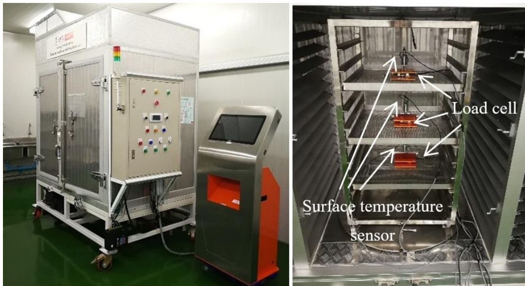
ภาพที่ 3.8 เครื่องทำแห้งที่ติดตั้งตัวรับรู้น้ำหนักและตัวรับรู้อุณหภูมิแบบไม่สัมผัส
