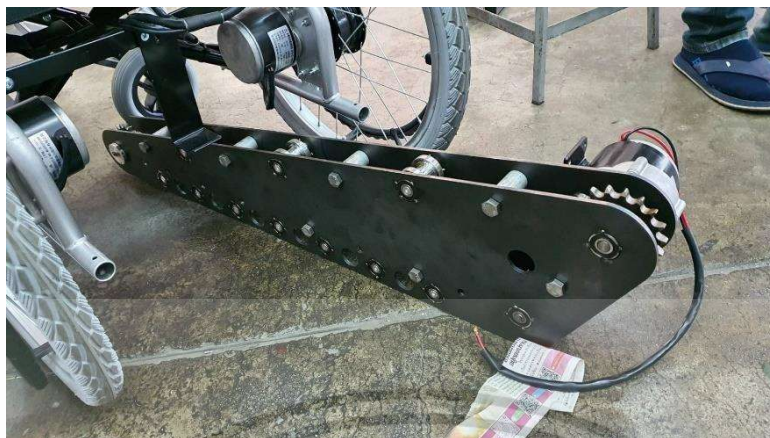
(ก) ตำแหน่งการเชื่อมต่อและจัดวางล้อสายพาน
