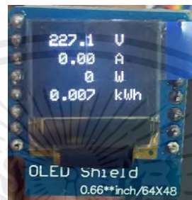
รูปที่ 4.1.3 อ่านค่าพลังงานไฟฟ้าจากหน้าจอ OLED
