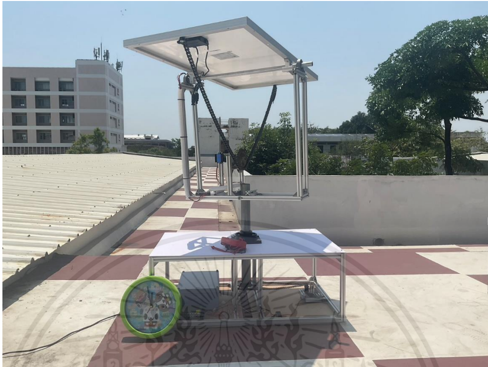
รูปที่ 11 แผงโซลาร์เซลล์แบบค้นหาแสงในวันที่ฟ้าโปร่ง ณ เวลา 12.00 นาฬิกา
