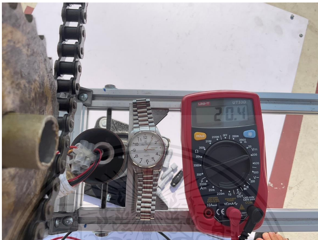
รูปที่ 20 ค่าแรงดันที่ผลิตได้ของแผงโซลาร์เซลล์แบบติดตามแสง ณ 15.05 นาฬิกา
