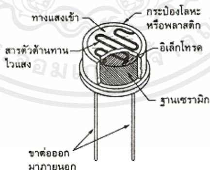
รูปที่ 2.8 โครงสร้างของ LDR
