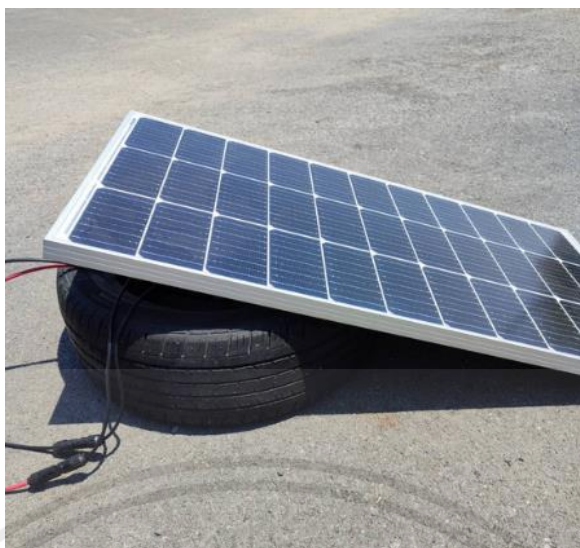
รูปที่ 4.3 แผงโซลาร์เซลล์วางในมุม 15 องศาใต้ วันที่ท้องฟ้าเปิด
