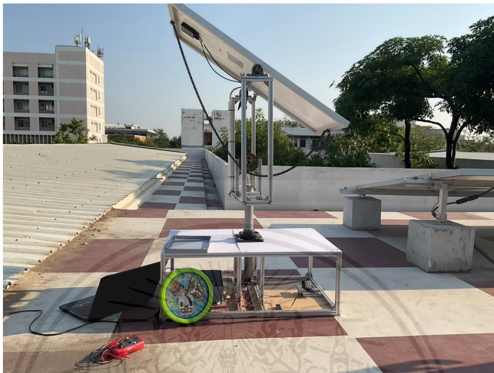
รูปที่ 13 แผงโซลาร์เซลล์แบบค้นหาแสงในวันที่ฟ้าโปร่ง ณ เวลา 17.00 นาฬิกา
