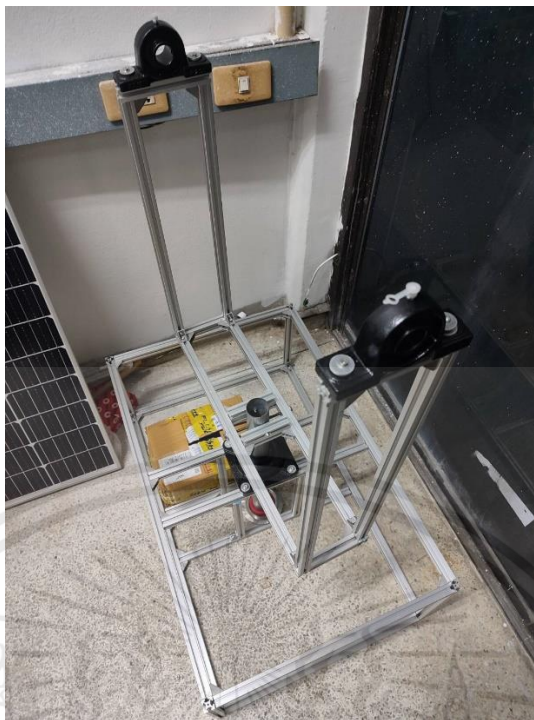
รูปที่ 7 ติดตั้งตลับลูกปืน
