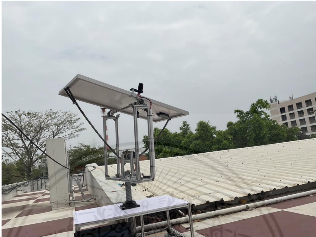
รูปที่ 9 แผงโซลาร์เซลล์แบบค้นหาแสงในวันที่ฟ้าครึ้ม
