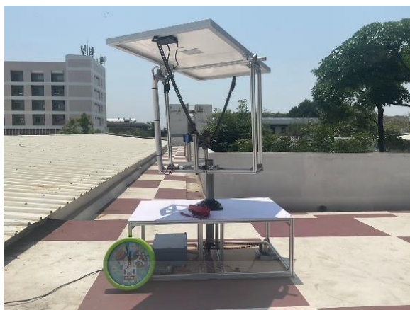
รูปที่ 4.4 แผงโซล่าเซลล์หมุนตามทิศทางแสงอาทิตย์ วันที่ท้องฟ้าเปิด
