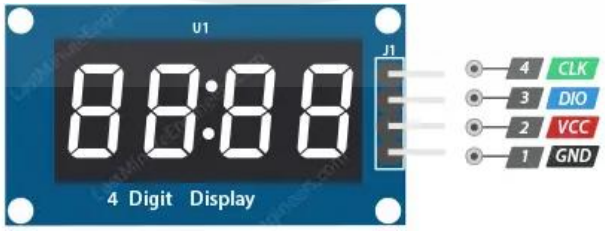
รูปที่ 2.8 ขาของโมดูล TM1637 ที่มา : https://lastminuteengineers.com
