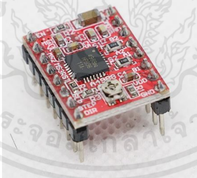
ภาพที่ 2.3 (ข) โมดูล A4988 ควบคุม Stepper Motor ที่มา https://fu.lnwfile.com/_fu/_raw/3r/lf/sx.jpg
