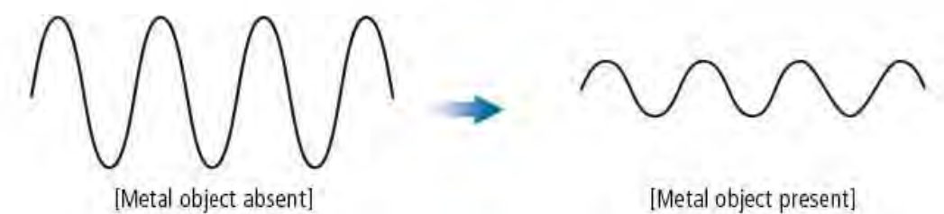
รูปที่ 2.11 การเปลี่ยนแปลงของสัญญาณออสซิลเลทเมื่อมีวัตถุโลหะในระยะสนามแม่เหล็ก
