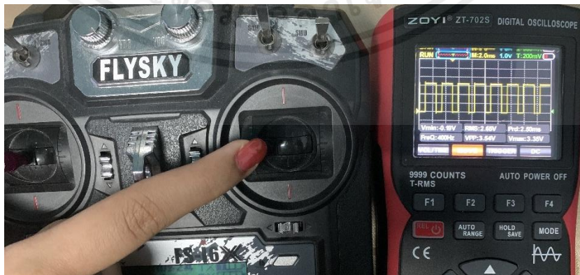
รูปที่ 4.19 ค่า pwm ของมอเตอร์ฝั่งขวาด้านหลังตอนบังคับโดรนให้เลี้ยวซ้าย
