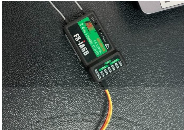
รูปที่ 3.11 ติดตั้งรีซีฟริโมท
