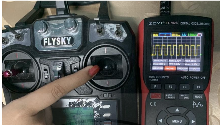
รูปที่ 4.20 ค่า pwm ของมอเตอร์ฝั่งซ้ายด้านหลังตอนบังคับโดรนให้เลี้ยวซ้าย
