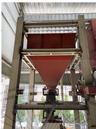
ภาพที่ 4.1 ไซโลเก็บเชื้อเพลิงก่อนเข้าเครื่องบด
