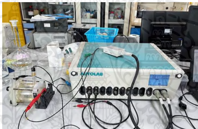
รูปที่ 3.12 แสดงชุดเครื่องมือทดสอบการกัดกร่อน AUTOLAB รุ่น PGSTAT302N
