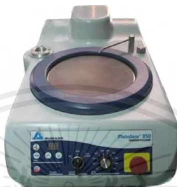
รูปที่ 3.10 เครื่องขัดผิวชิ้นทดสอบแบบจานหมุนยี่ห้อ BUEHLER รุ่น MetaServ 250
