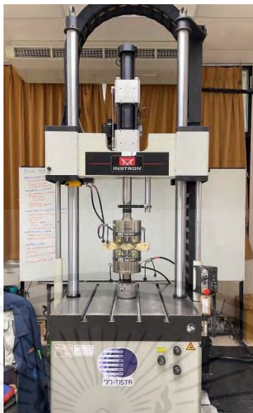
รูปที่ 3.6 เครื่องทดสอบความล้าระบบไฮดรอลิค Instron : 8802
