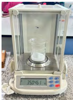
รูปที่ 3.13 การชั่งตวงเกลือเคมี 35 กรัม สำหรับเตรียมสารละลายโซเดียมคลอไรด์ 3.5%
