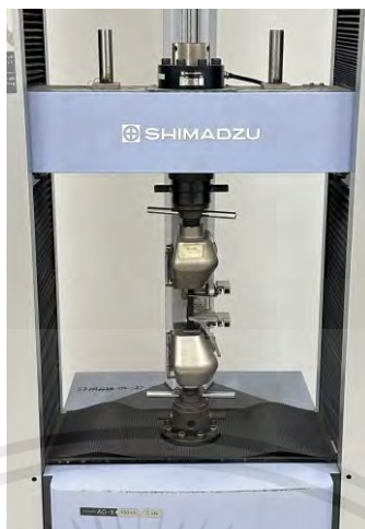
รูปที่ 3.4 แสดงเครื่องทดสอบแรงดึง รุ่น Shimadzu autograph AG-X
