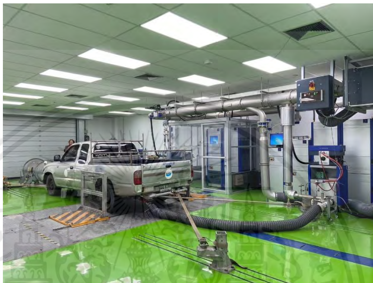
รูปที่ 3.10 การทดสอบเพื่อหาปริมาณของอนุภาคฝุ่นที่ถูกปล่อยออกมาจากเครื่องยนต์ดีเซลที่ใช้ น้ำมัน B7 และ B100 ณ ห้องปฏิบัติการตรวจวัดมลพิษจากยานพาหนะ กรมควบคุมมลพิษ
