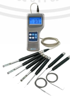
รูปที่ 3.4 เครื่องวัดแบบลวดร้อน (Hot wire)
