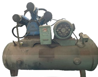
รูปที่ 3.2 เครื่องปั๊มลม (Air Compressor)
