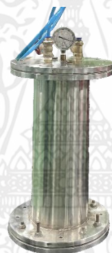
รูปที่ 3.3 ถังสุญญากาศ (Vacuum Tank)
