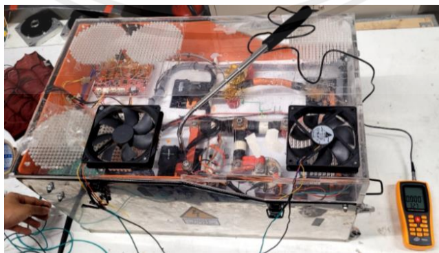
รูปที่ 3.40 แสดงตำแหน่งการวัดความเร็วลมตำแหน่งที่ 1
