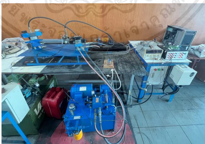
รูปที่ 1.1 แสดงชุดทดลองอิเล็กทรอนิกส์ไฮดรอลิกควบคุมที่ป้อนเดิมที่มีอยู่
