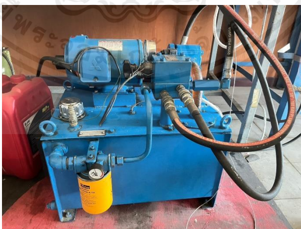
รูปที่ 3.3 แสดงชุดต้นกำลังไฮดรอลิก
