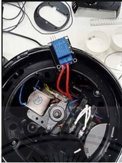
รูปที่ 3.19 แสดงการต่อ Relay แทน Timer switch
