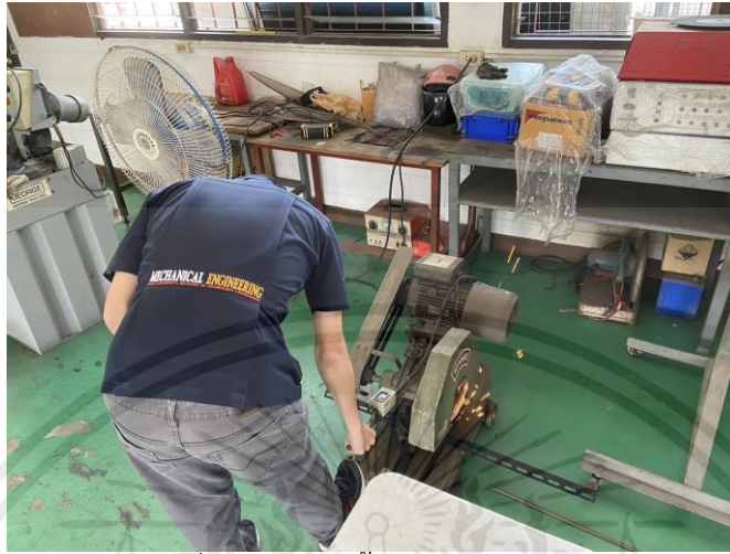
รูปที่ 3.27 แสดงขั้นตอนตัดเหล็กฉาก
