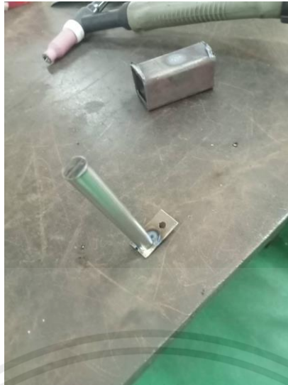
รูปที่ 3.17 แสดงการทำเกลียวเพลลาเหล็กและเชื่อมเข้ากับแผ่นสแตนเลสเพื่อยึดกับหม้อ(ต่อ)
