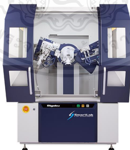
รูปที่ 2.21 เครื่องวิเคราะห์การเลี้ยวเบนของรังสีเอ็กซ์ ยี่ห้อ Rigaku รุ่น SmartLab [30]
