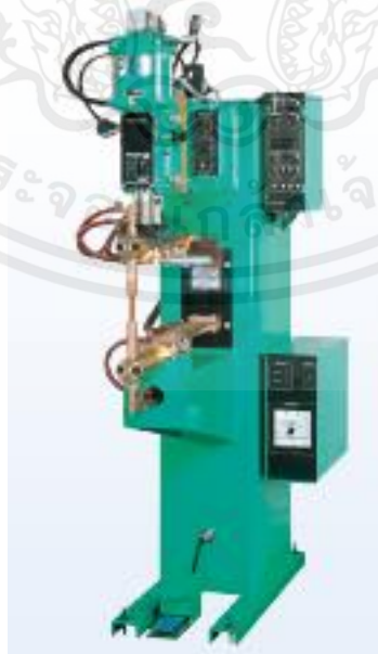
รูปที่ 3.6 เครื่องเชื่อมความต้านทานแบบจุด [16]
