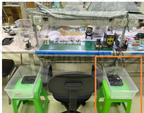
รูปที่ 3.27 กล่องใส่แผงวงจรที่ทำการบัดกรีเสร็จเรียบร้อยแล้ว
