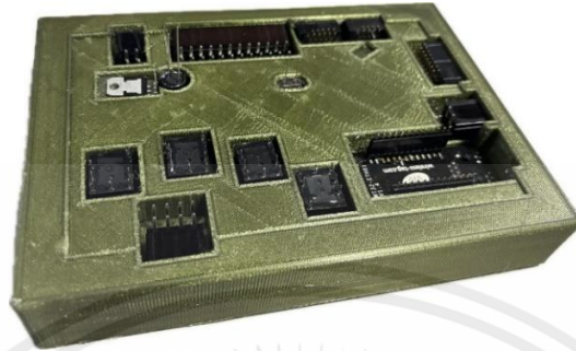
รูปที่ 3.39 ชิ้นส่วนอิเล็กทรอนิกส์ขณะใส่ลงในแบบจำลองที่ 2
