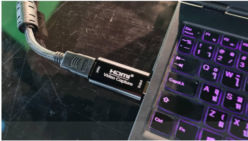
ภาพที่ 23 ตัว Capture card แปลง HDMI เข้าสู่คอมพิวเตอร์
