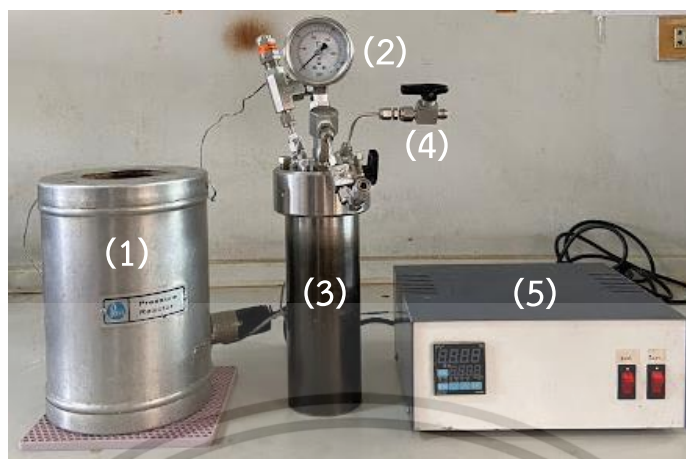
รูปที่ 3.2 เครื่องสกัดด้วยของเหลวอัดความดัน
