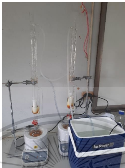
ภาพที่ ง.7 เครื่องสกัด Soxhlet Extraction
