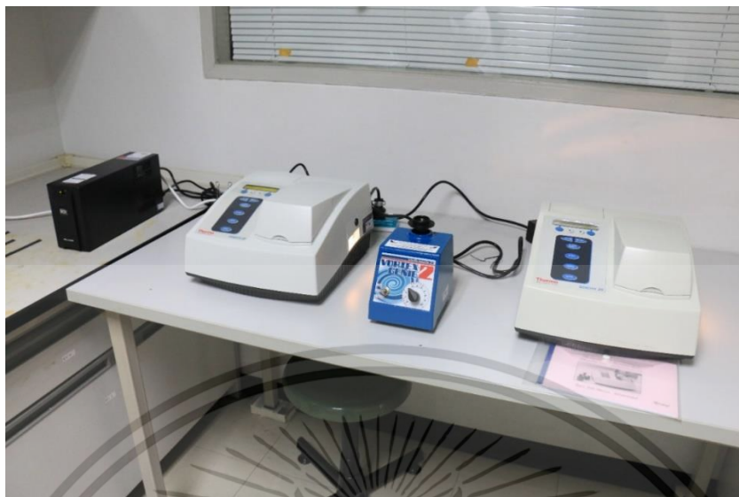
ภาพที่ ข.2 เครื่องวัดค่าความดูดกลืนแสง (Thermo รุ่น Genesys 20)
