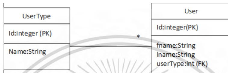
รูป 2.10 ความสัมพันธ์ของตาราง UserType กับ User
