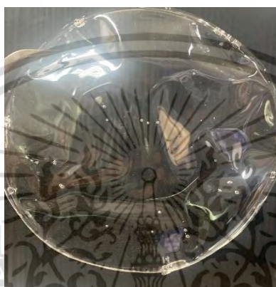
ภาพที่ ก.1 ฟิล์มที่ขึ้นรูปด้วยโพลีไวนิลแอลกอฮอล์ (PVA) โดยไม่มีส่วนผสมของ Jackfruit powder
