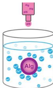
ภาพที่ 2.3.1 การขึ้นรูปทรงกลมแบบพื้นฐาน (basic spherification)
