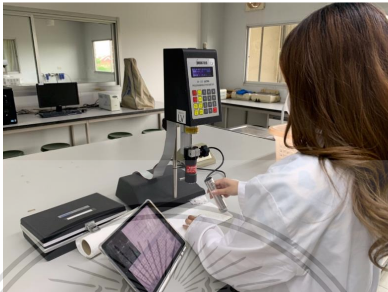
ภาพที่ ง.3 การทดลองวัดหาค่าความหนืดผ่านเครื่อง Viscometer Brookfield
