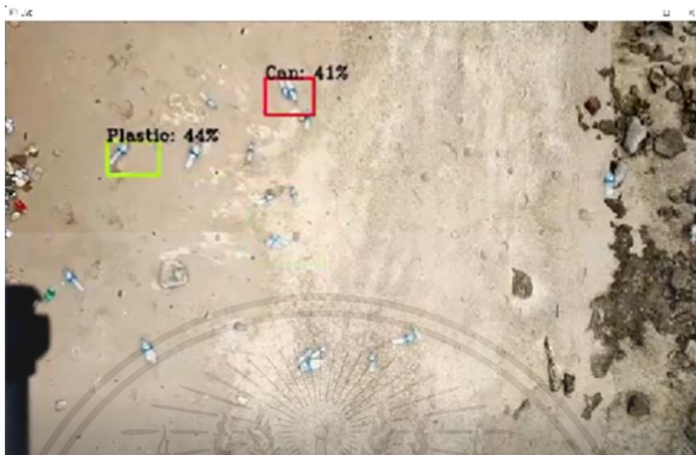
รูปที่ 4.10 ผลการทดลองตรวจจับภาพขวดที่ความสูง 4 เมตร
