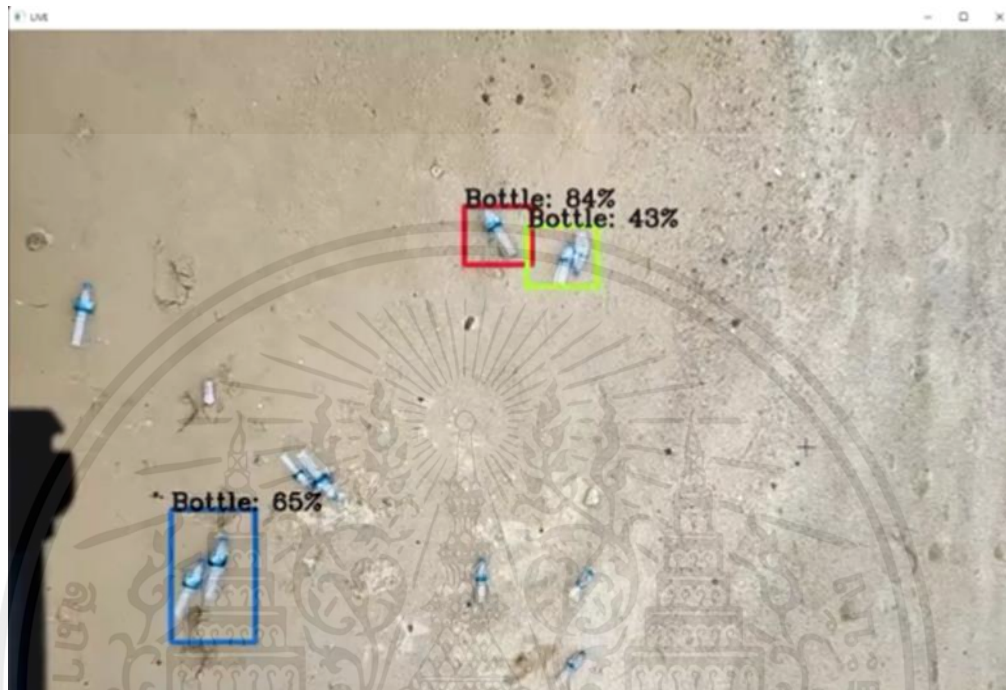
รูปที่ 4.8 ผลการทดลองตรวจจับภาพขวดที่ความสูง 2 เมตร
