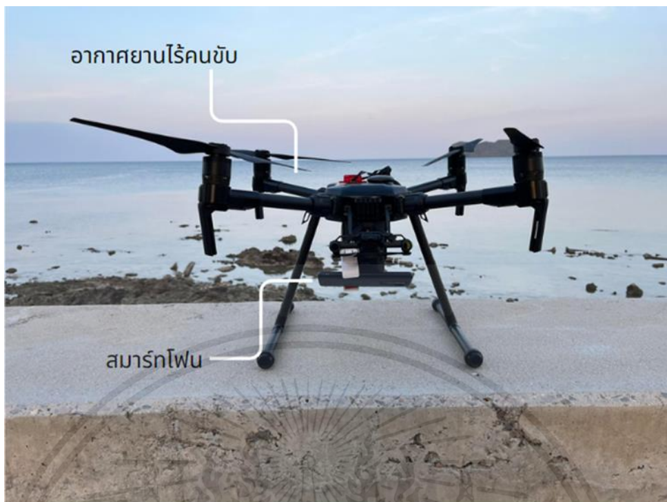
รูปที่ 4.2 อากาศยานไร้คนขับที่ติดตั้งอุปกรณ์พร้อมสำหรับการทดลอง
