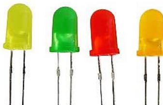
รูปที่ 2.14 ไดโอดเปล่งแสงหรือแอลอีดี
