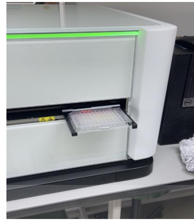
ภาพที่ ก.8 การหาปริมาณสารต้านอนุมูลอิสระ โดยใช้เครื่องไมโครเพลทรีดเดอร์ (Microplate Reader)
