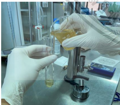
ภาพที่ ก.5 การหาปริมาณแอลกอฮอล์ โดยใช้ไอบีทีโอมิเตอร์
