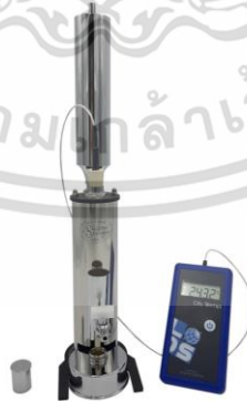
ภาพที่ ก.5 การหาปริมาณแอลกอฮอล์ โดยใช้ไอบีทีโอมิเตอร์
