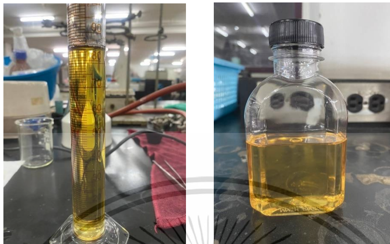
ภาพที่ ข.7 การวัดปริมาณน้ำมันหล่อลื่นชีวภาพและผลิตภัณฑ์น้ำมันหล่อลื่นชีวภาพ
