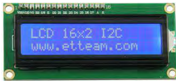
รูปที่ 2.6 จอแอลซีดีขนาด 16x2 ตัวอักษร (ที่มา: http://www.ett.co.th )
