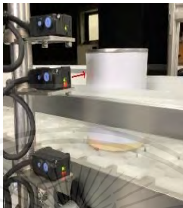
รูปที่ 4.2 ไฟโตอิเล็กทรอนิกส์เซอร์ตัวที่ 2 ตรวจจับชิ้นงานขนาดกลาง
