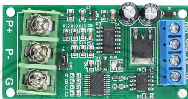
รูปที่ 2.13 โมดูลแปลงสัญญาณ (PT100 Thermocouple RS485)
