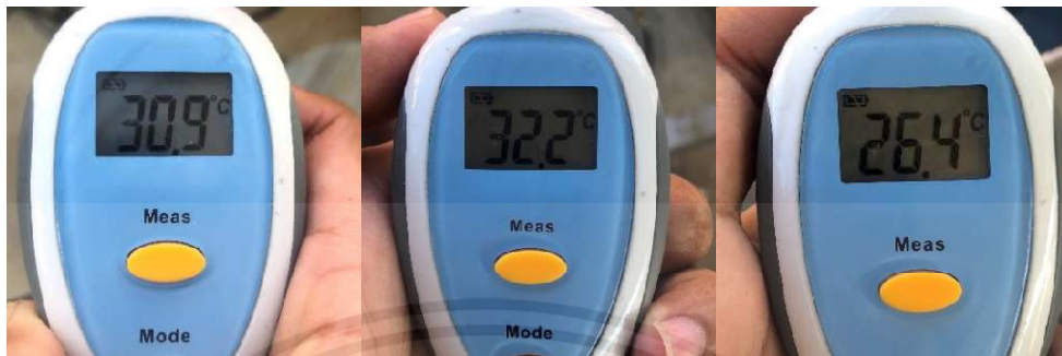
รูปที่ 4.1 อุณหภูมิจากเครื่องวัดอุณหภูมิจานาเรตของ น้ำ ใอน้ำ และน้ำหล่อเย็นตามลำดับ
