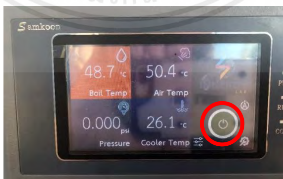
รูปที่ 4.4 เมื่ออุณหภูมิต่ำกว่า 48.8 องศาเซลเซียส ระบบจะกลับมาทำงาน ไฟสถานะแจ้งเตือนเป็นเขียว
