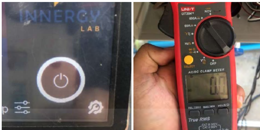
รูปที่ 4.6 เมื่อเปิดการใช้งานเครื่อง กระแสของระบบควบคุมจะอยู่ที่ 0 แอม
