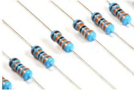
รูปที่ 2.19 ตัวต้านทานชนิดค่าคงตัว (ที่มา: https://www.ec-bot.com/ )
