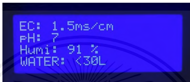
รูปที่ 4.8 แสดงผลระดับน้ำที่ต่ำกว่า 30 ลิตร บนจอแอลซีดี
