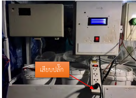
รูปที่ 4.15 เปิดระบบควบคุมการปลูกผักแบบแอโรโพนิกส์
