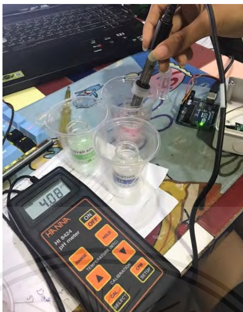
รูปที่ 4.6 วัดเทียบกับเครื่องวัดพีเอชมิเตอร์
