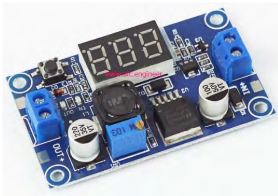
รูปที่ 2.4 วงจรลดแรงดันไฟ (ที่มา: https://shorturl.asia/Nq9IV )
