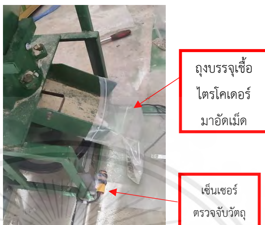
รูปที่ 4.16 ขณะมีถุงบรรจุเชื้อไตรโคเดอร์มาอัดเม็ด
